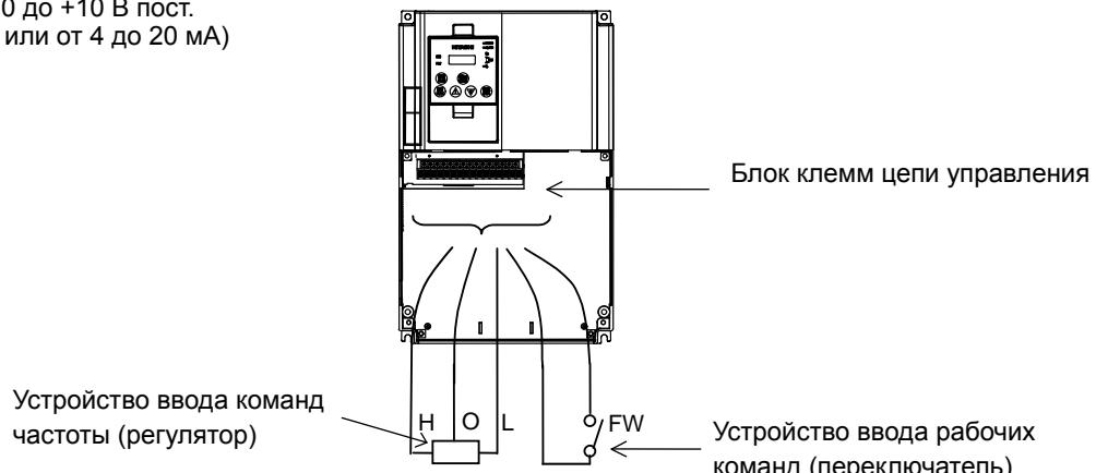
(3) Ввод рабочих команд и команд частоты и через цифровую панель управления, и через клеммы цепи управления
