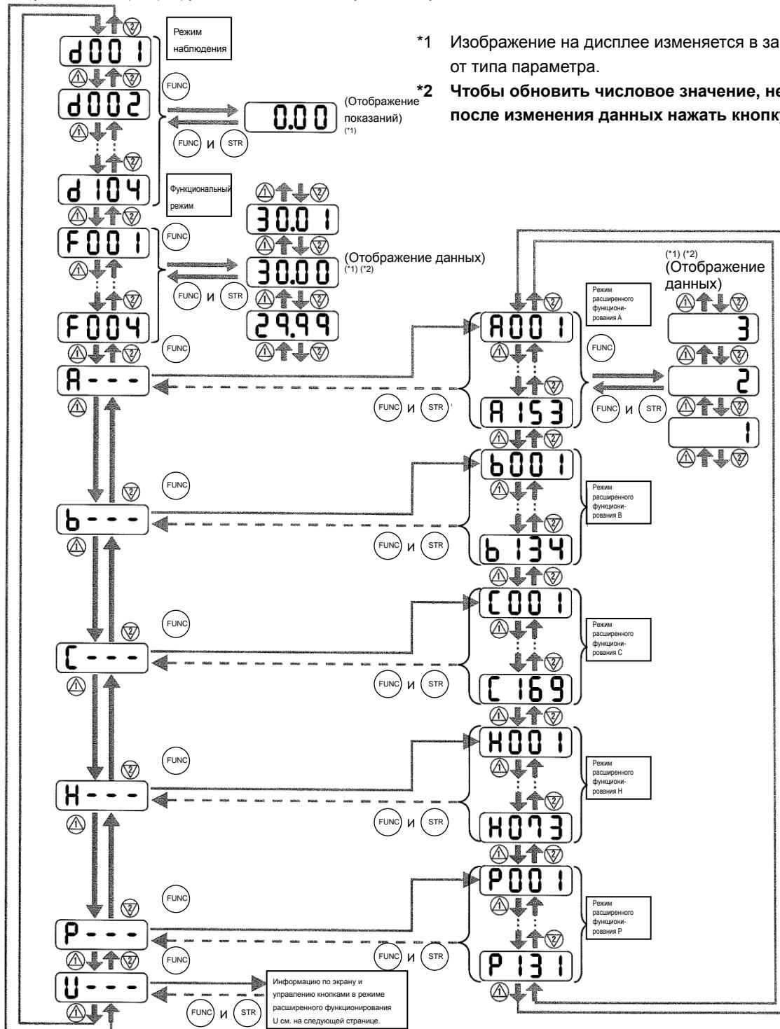
(3) Отображение кодов/значений и управление кнопками в режиме расширенного функционирования U
