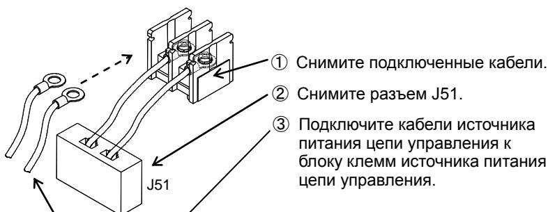
При подключении отдельных источников питания к клеммам электропитания цепи управления (R0 и T0) и основной цепи (R, S и T):
